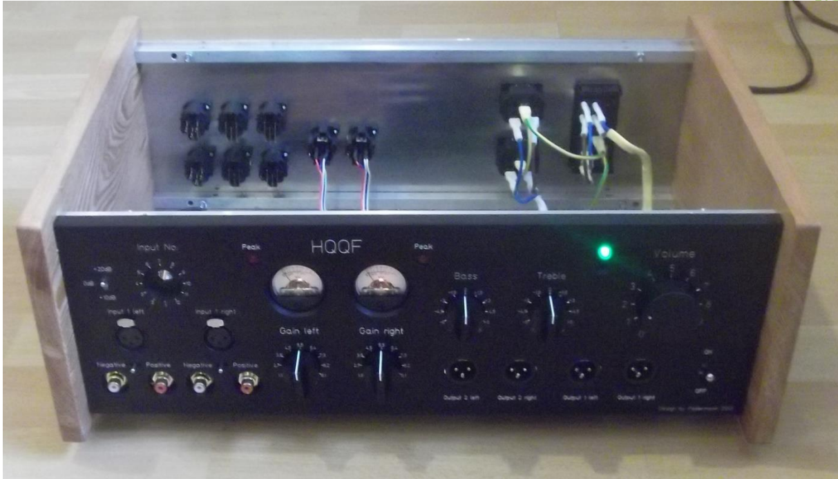
Obrázek 9: Předzesilovač HQQF s precizním nastavením zisku a charakteristik
